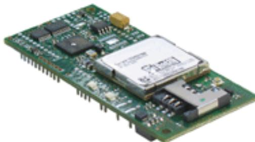
Figura 7 – Módulo GPRS integrado
